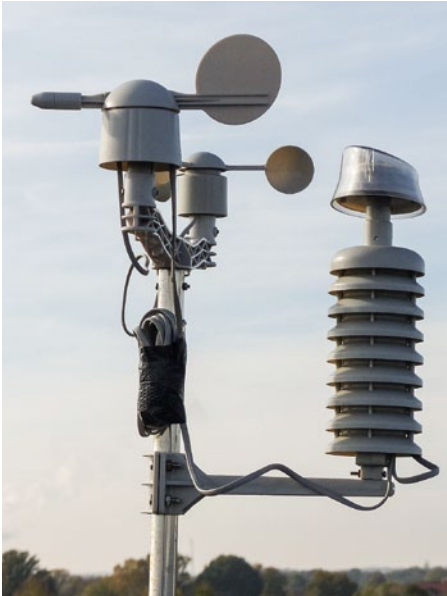
Genug Wind? Eine Messstelle erhebt die Winddaten.
